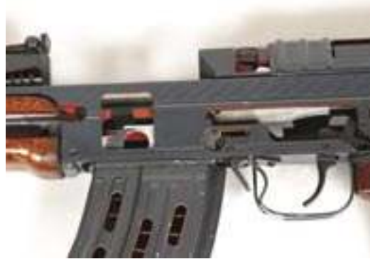
Poloha součástí závěru v době, kdy je závěr v zadní poloze
